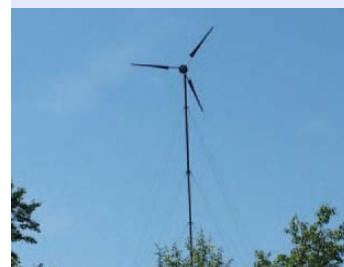
Εικόνα 7. Μικρή ανεμογεννήτρια με ισχύ 10 kW
