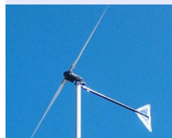
Εικόνα 18. Μικρή ανεμογεννήτρια οριζόντιου άξονα με δύο πτερύγια Πηγή: http://www.archiexpo.com
